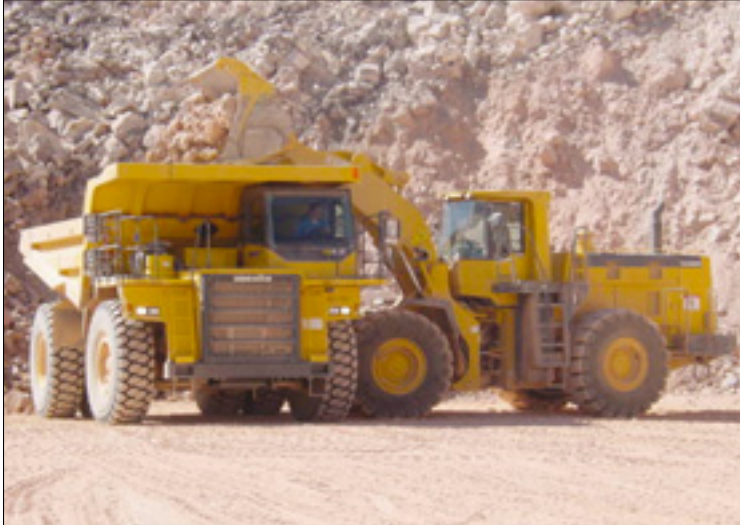
Una flota de HD465-7 y WA600-3 cumple eficientemente "cucharón por cucharón" con las cuotas de producción de la cantera.
