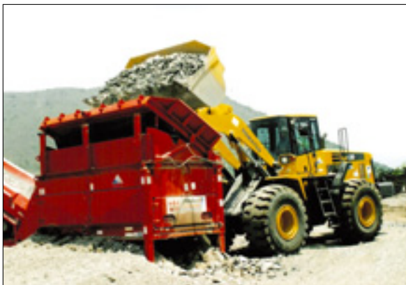
La WA430-5 se utiliza en la nueva manipulación del material triturado para la selección final de los agregados por granulometría.
