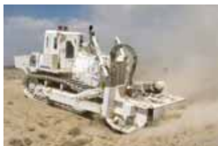
La máquina para el desminado se ha construido sobre la base de los tractores de orugas Komatsu.
