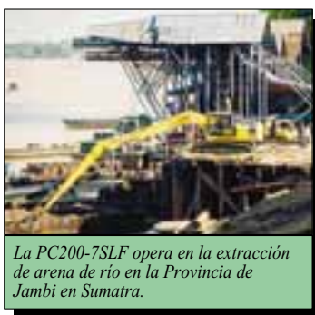
Peso de operación: 21.970 kg (48.435 lb) Potencia al volante: 107 kW (143 HP) @ 1.950 rpm
