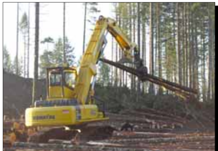
La cargadora de troncos clasifica y carga troncos después de que han sido procesados por una desramadora por sacudidas.
