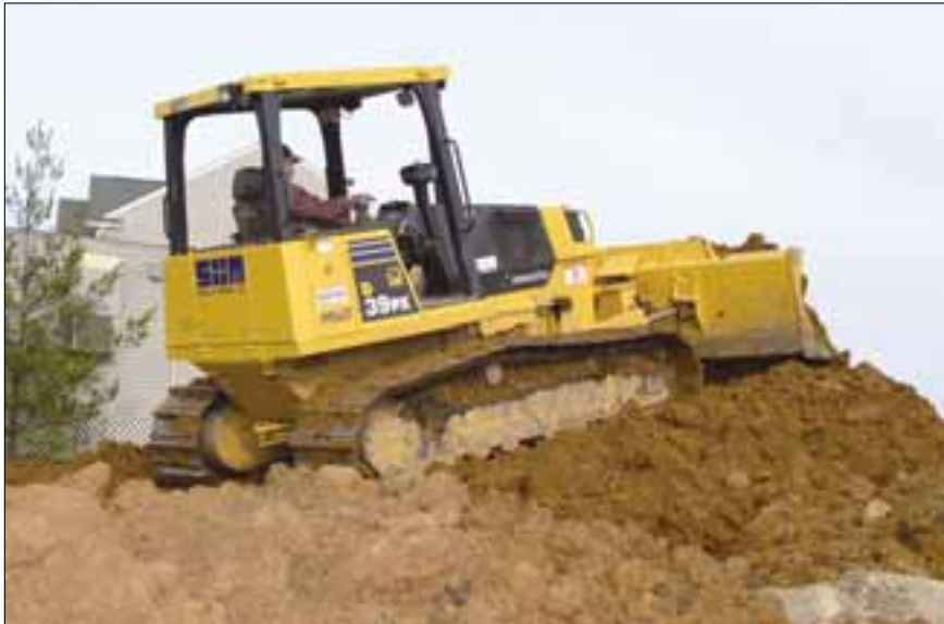
La Transmisión Hidrostática y la palanca de mando controlada con la palma de la mano de Komatsu hacen que el tractor D39PX-21A sea fácil de operar.
