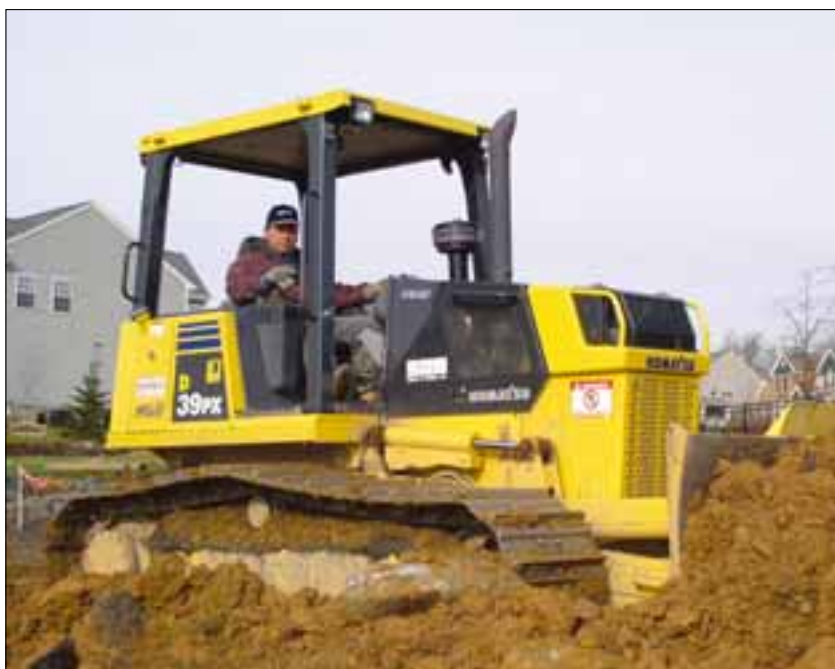
La visibilidad clara de la hoja del tractor aumenta enormemente la eficiencia de la nivelación y reduce las conjeturas por parte del operador.
