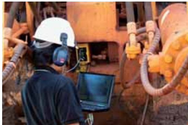
Descarga y análisis de los datos del VHMS en una computadora personal
