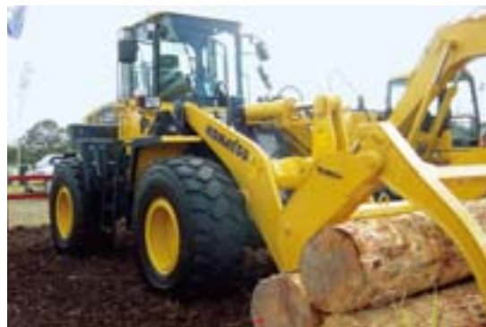
La cargadora sobre ruedas WA320 equipada con una grapa para troncos
