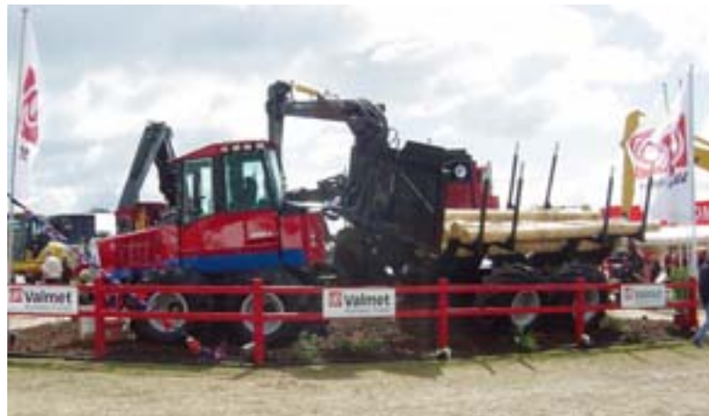
El tractor forestal transportador 890.2, que recoge los troncos con su grapa y los coloca a la orilla del camino, se desplaza rápida y poderosamente incluso en terreno difícil.
