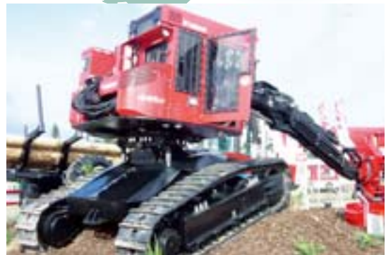
El sistema de nivelación de la taladora agrupadora 445EXL permite subir y bajar pendientes empinadas.
