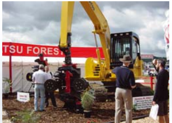
La excavadora hidráulica PC200LC montada con un cabezal cosechador
