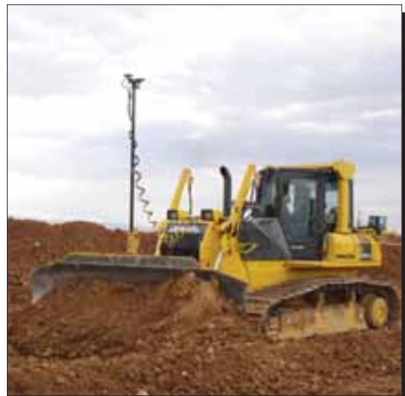
Gilbert Development compró este tractor sobre orugas D65 con un sistema Topcon totalmente automatizado en Komatsu Field Days 2006.
