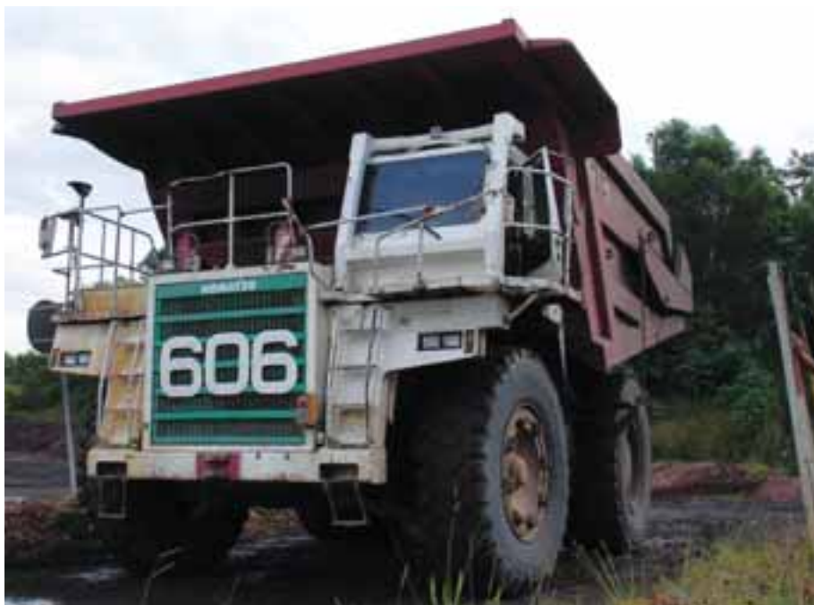
Camión volquete HD785 bajo un contrato de mantenimiento completo con una lectura del medidor de servicio de más de 80.000 horas
