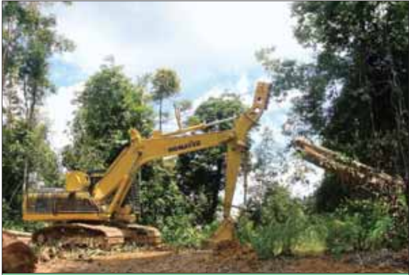
El cabrestante portátil giratorio PC200 en acción
