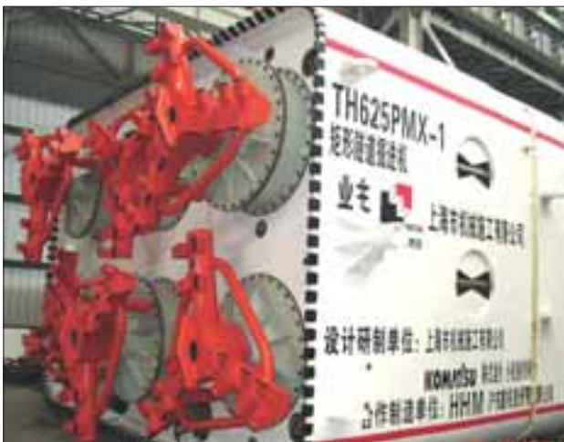
Máquina tipo semi-escudo rectangular utilizada para perforar una acera subterránea para la Línea No. 6 del subterráneo de Shanghai
