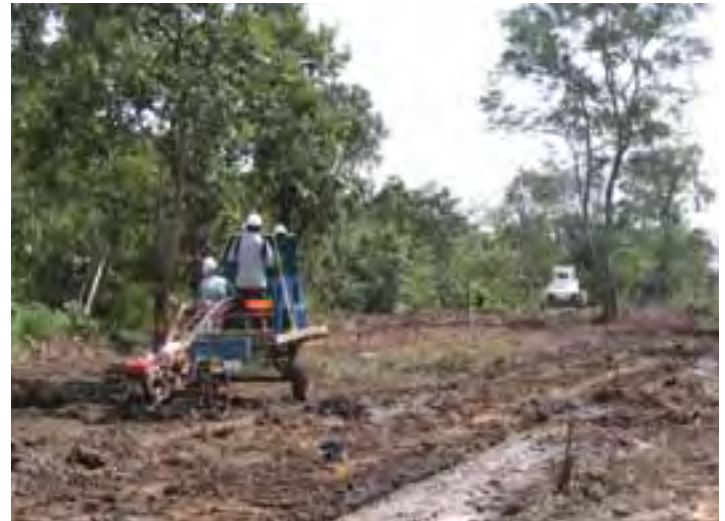
Operación por control remoto del equipo para desminado
