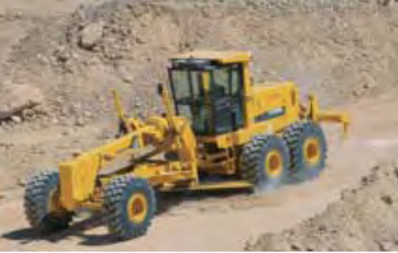
La motoniveladora GD825A realiza el mantenimiento del camino de transporte
