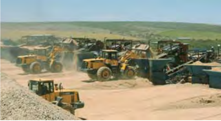
Las cargadoras sobre ruedas WA430 colocan grava diamantífera aluvial en las plantas de clasificación.
